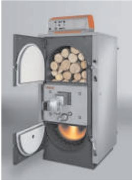
**Unical Holz - Stahlheizkessel GASOGEN SHG G3**, zur geregelten Verfeuerung von Stück- und Scheitholz mit unterem Abbrand mit Druckgebläse Betriebstemperatur 75 - 90 °C. Bauartzugelassen nach DIN 4702 und EN 303.5.
