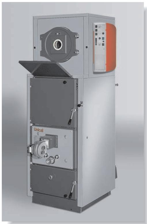
Alles wird vollautomatisch geregelt. Holzvergaserkessel mit aufgesetztem Öl- oder Gaskessel. Die Umschaltung auf die Alternativenergie erfolgt automatisch nach dem Ausbrand des Holzvergaserkessels.
